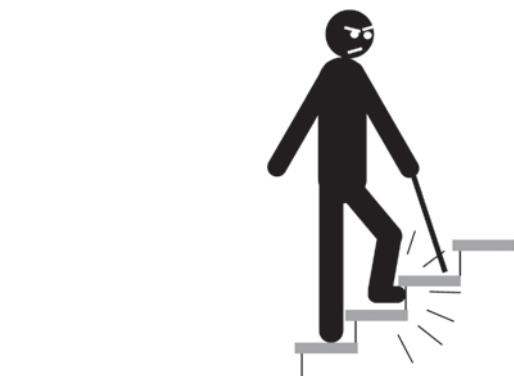
Figure 7 : Les nez de marchessailants peuvent mettre les personnes à motricité réduite en situation de handicap, notamment les personnes âgées qui ont du mal à lever les jambes
