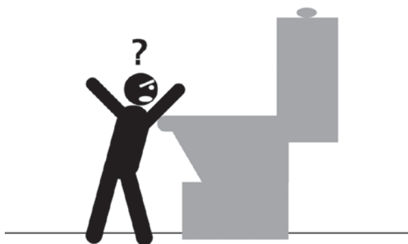
Figure 6 : Les sanitaires surélevés ne sont accessibles ni aux enfants, ni aux personnes de petite taille, ni aux personnes circulant en fauteuil de petit gabarit. Au lieu d'installer uniquement des sanitaires « pour fauteuil », mieux vaut alterner sanitaires surélevés et sanitaires banalisés
