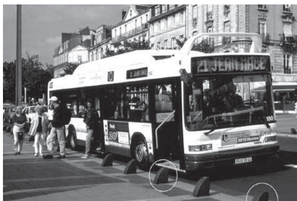
Figure 1 : Ville de Nantes : les bus de la « Tan » équipés de planchers bas favorisent l'accessibilité à condition que les bornes anti-stationnement ne gênent pas le passage (Photo Jacques Pacor, Semitan)
