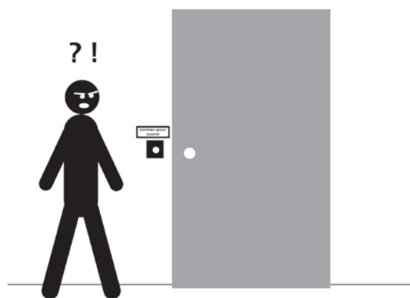
Figure 3 : Le bouton d'appel extérieur doit être contrasté par rapport à son support, bien mis en lumière et l'information associée doit être lisible en position assis et debout
