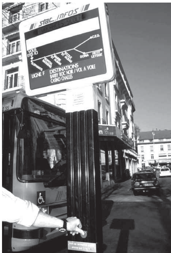
Figure 2 : Ville de Chambéry : les bornes du bus parlent pour les non-voyants et sont lues par les malentendants. Elles informent sur les horaires et les déplacements (Photo Gilles Gorofolin)
